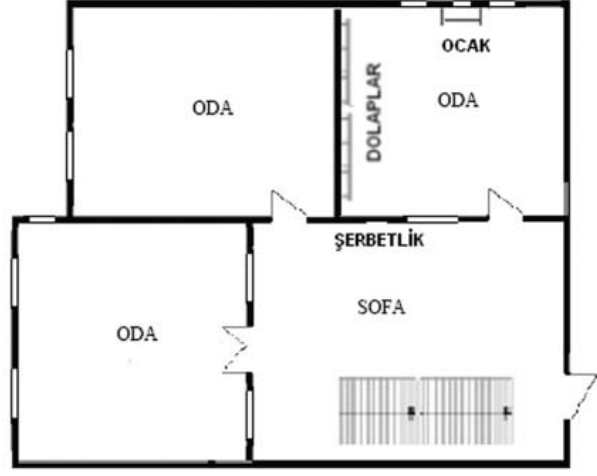
Levha-77: Remziye Tatar Evi'nin üst kat planı (Çizim D. Demirci).
